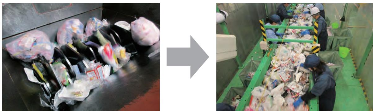
※袋を機械で破き、コンベアに載せて作業員が袋の中身を確認し不適物を除去
