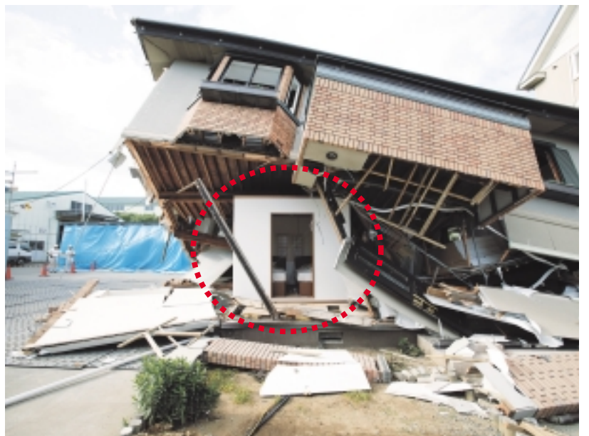
倒壊実験後の耐震シェルター
