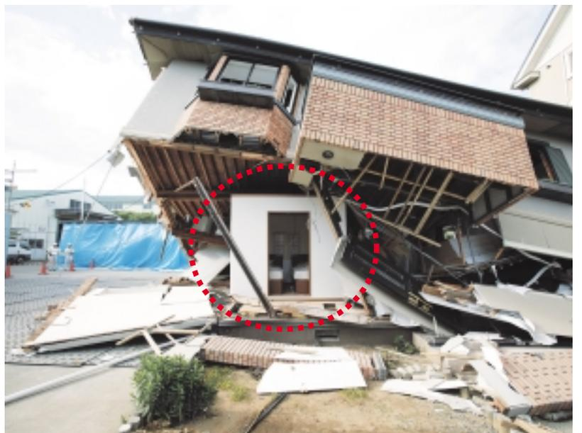
倒壊実験後の耐震シェルター
