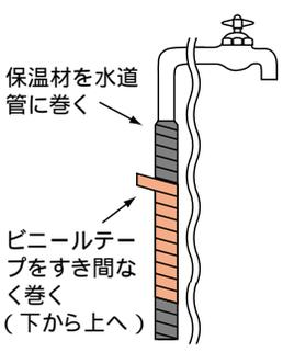
左図のように、保温材を巻き、保温材がぬれて凍らないよう、ビニールテープですき間なく下から巻きあげます。
