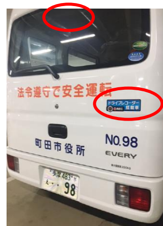
後方のカメラはリアガラスに設置します。 また、後方に「ドライブレコーダー搭載 車」の表示をしています
