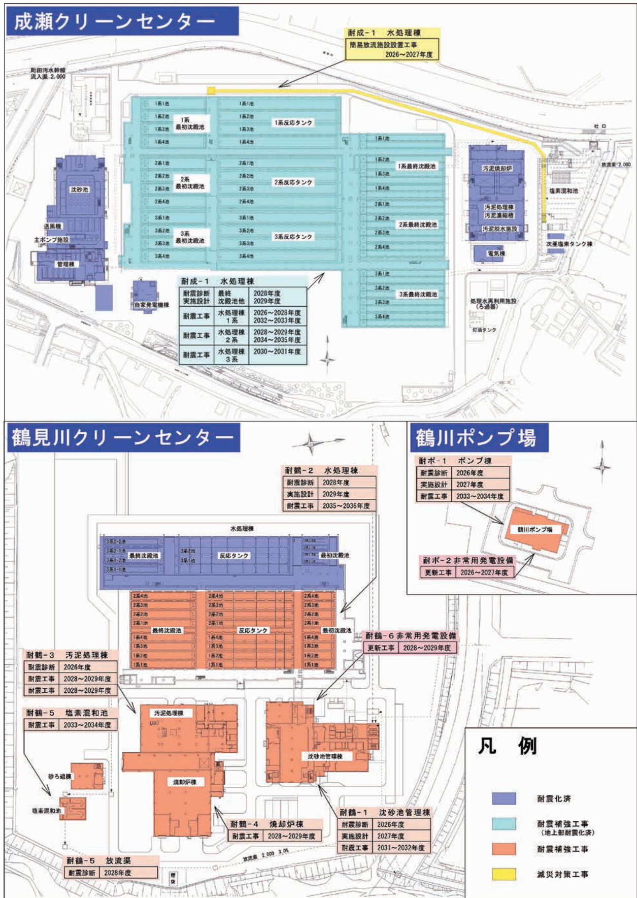
図6-22 下水処理場・鶴川ポンプ場の主な地震対策工事実施箇所
