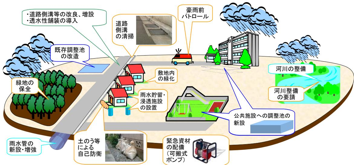
図 35 浸水対策の概要 (イメージ図)
