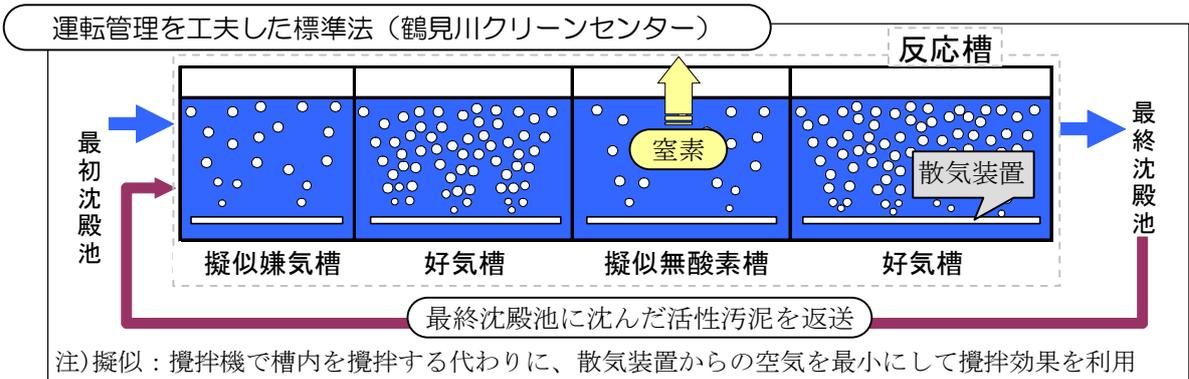
注) 擬似：攪拌機で槽内を攪拌する代わりに、散気装置からの空気を最小にして攪拌効果を利用
