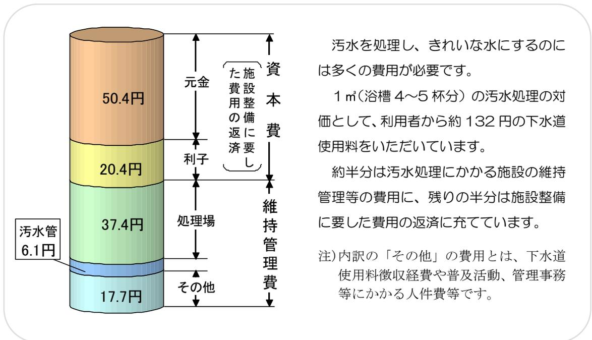
図 21 1 m<sup>3</sup>の汚水処理の対価 (下水道使用料) 132 円の内訳 (2009 年度実績)
