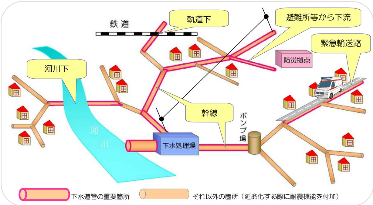
図 43 下水道管の耐震化の概要（イメージ図）
