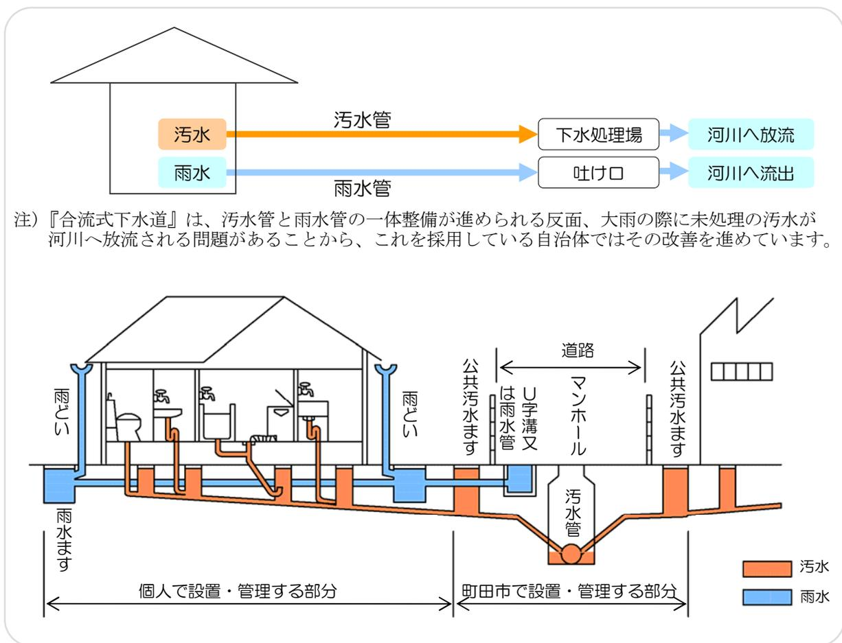
図 6 分流式下水道の概要
