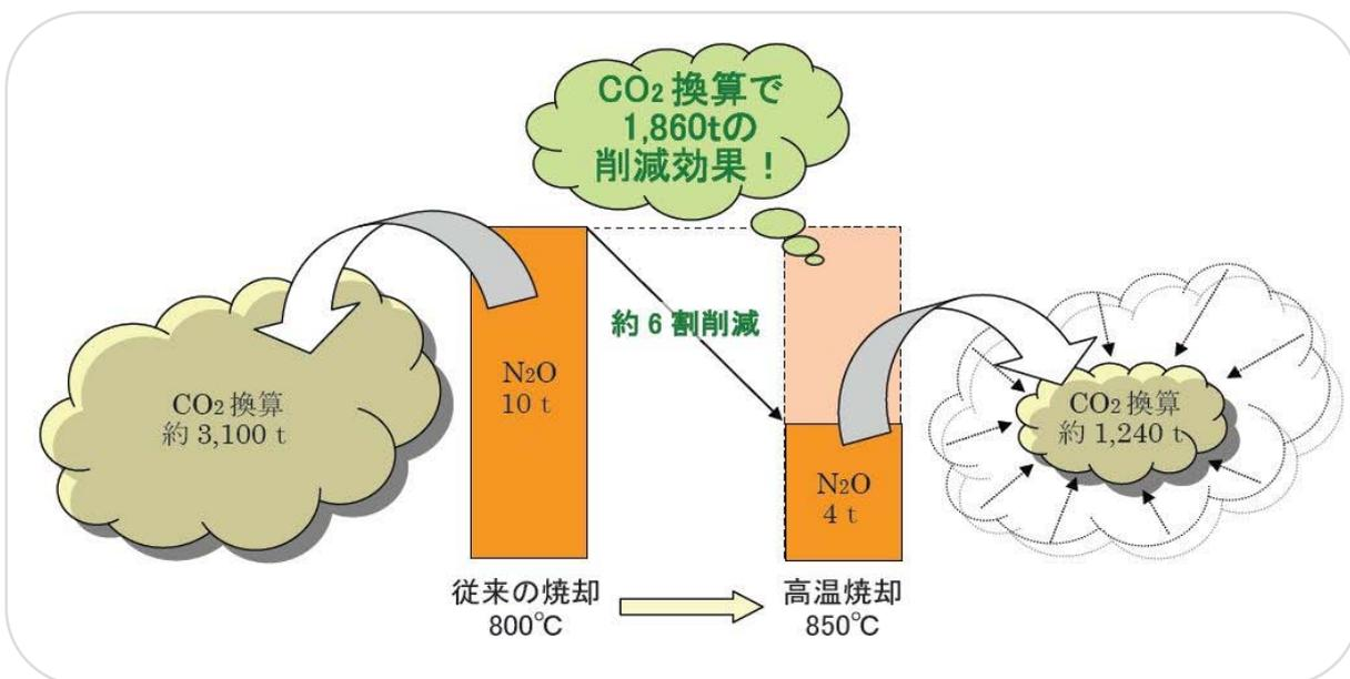
図 33 汚泥焼却により N<sub>2</sub>O が 10t 発生すると仮定した場合の高温焼却化による温室効果ガスの削減効果
