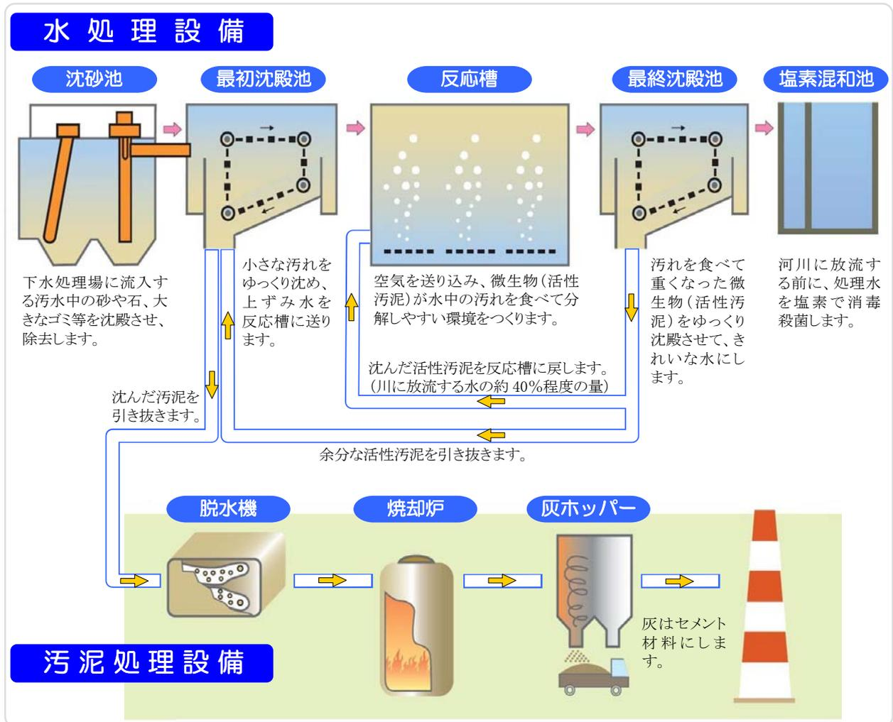
図 8 汚水処理の仕組み（標準法）
