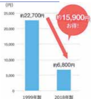
図 1999 年製と 2018 年製の冷蔵庫の年間電気代の比較
