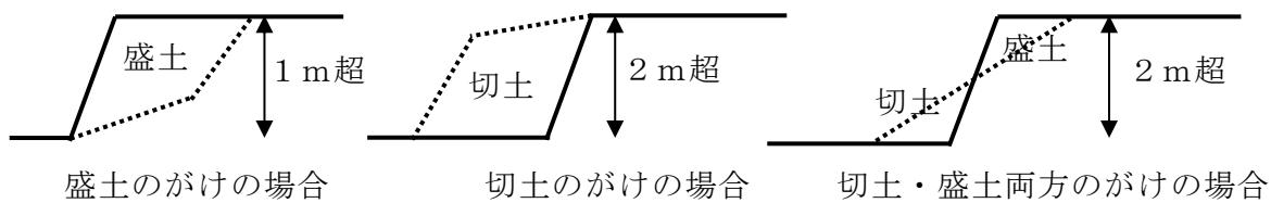
注) 既存のがけが1m未満であっても、新たな盛土により1mを超えるがけが生じる場合、既存のがけが2m未満であっても、新たな切土、切土・盛土両方により2mを超えるがけが生じる場合、許可が必要となる。
