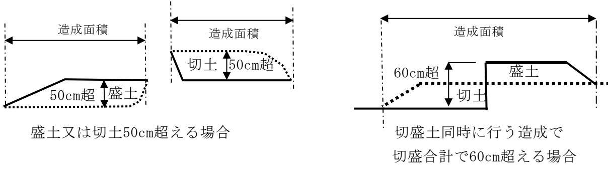
注) 実線は造成後の地盤面、破線は造成前の地盤面
