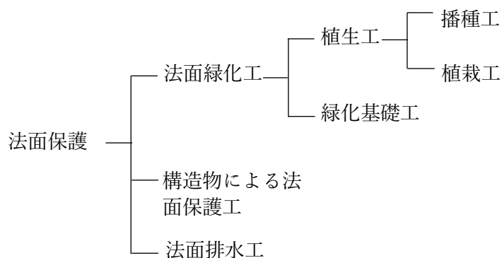
図 3-54 法面保護工の分類
