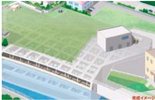
広場の下に整備された調節池 (境川木曾東調節池完成イメージ)
