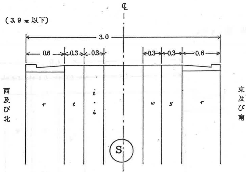
1. 路幅内には、電柱を建柱しないこととし、各戸引込線は直接又は共同法によること。
