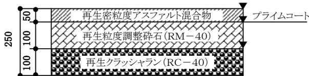
アスファルトコンクリート舗装 40型
