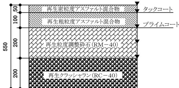
アスファルトコンクリート舗装 60型
