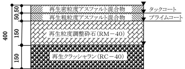
アスファルトコンクリート舗装 55型
