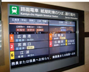
情報提供システム(ロケーションシステム等)
