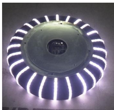
図 5-13 大口径スクリーニング用円盤型カメラ(左)、大口径スクリーニング用船型カメラ(右)
