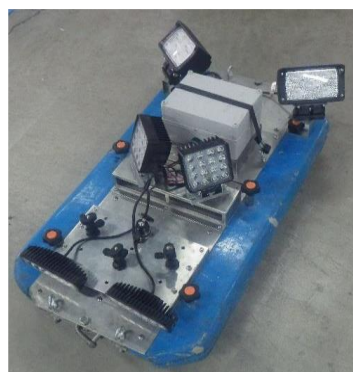
図 5-13 大口径スクリーニング用円盤型カメラ(左)、大口径スクリーニング用船型カメラ(右)
