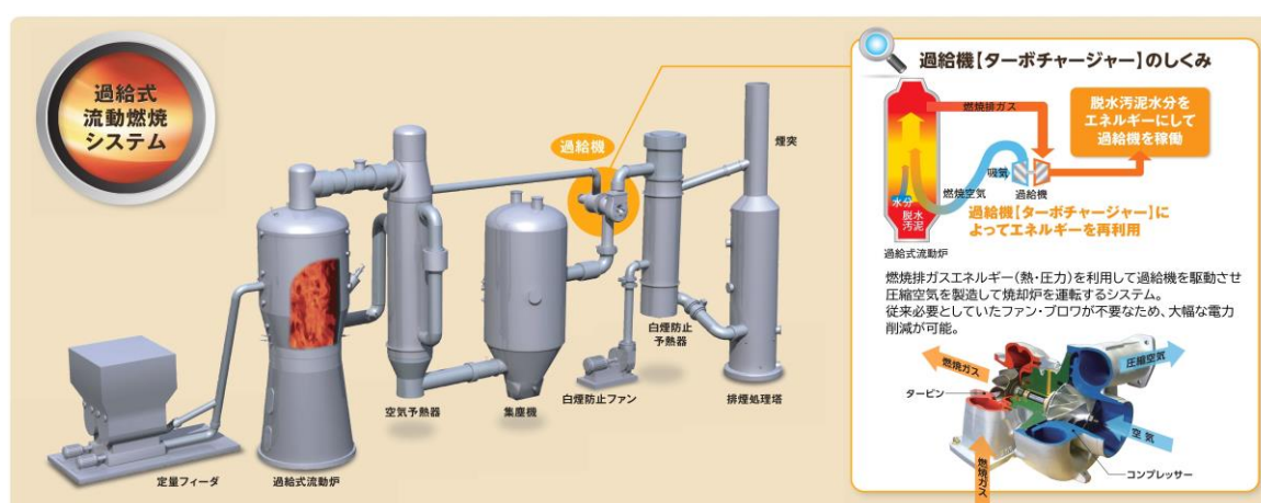
図 5-9 焼却排ガスのエネルギーを活用した過給式流動燃焼システム
