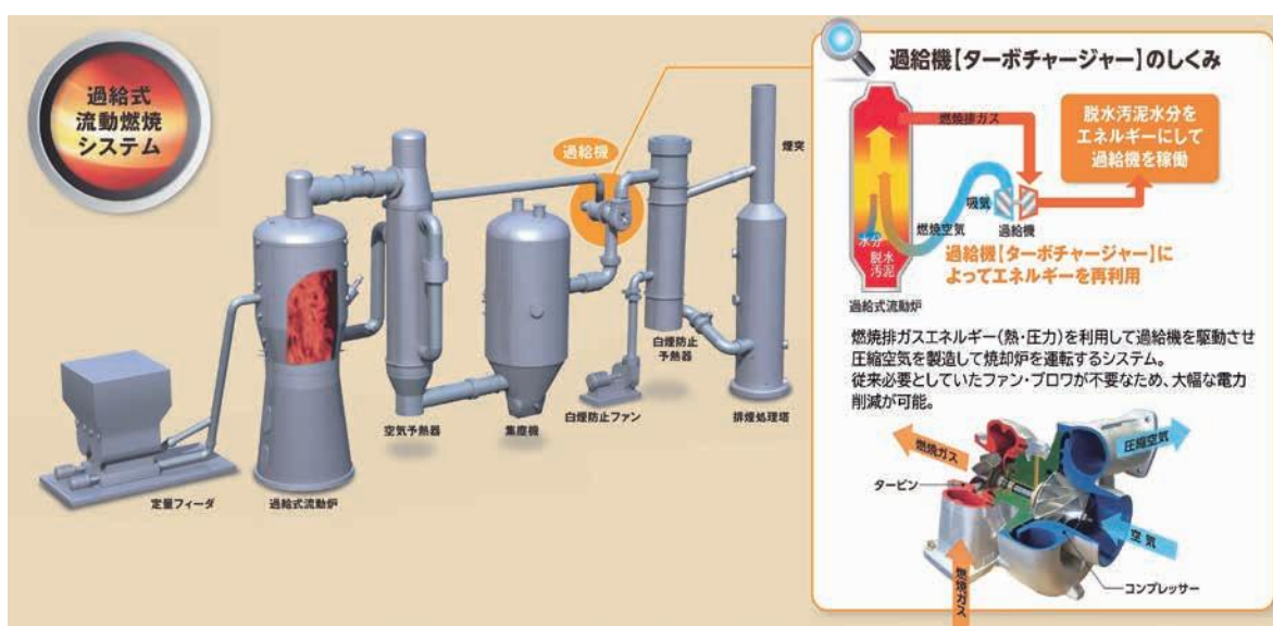
図5-9 焼却排ガスのエネルギーを活用した過給式流動燃焼システム
