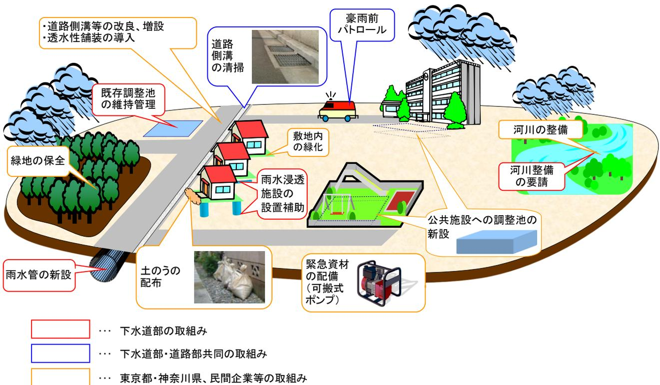
図 6-9 浸水対策の概要（イメージ）
