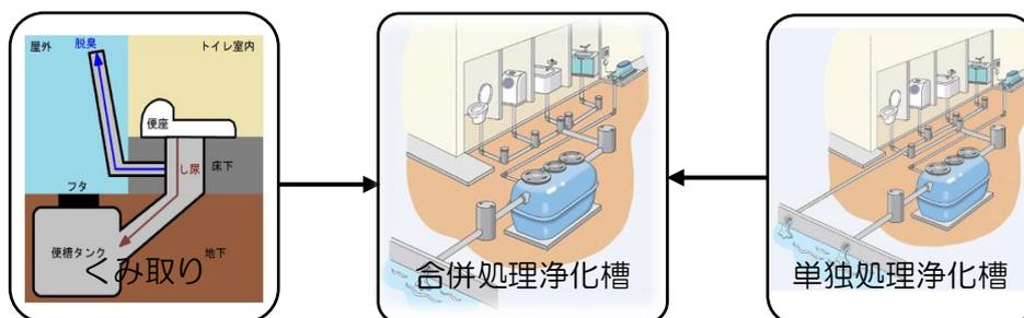
くみ取り便槽や単独処理浄化槽から合併処理浄化槽への切替え
