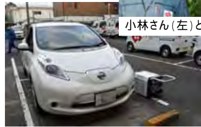
災害に備えたEV車と外部給電装置
