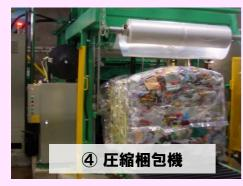
容リプラを圧縮し、プラスチックフィルムで梱包して、容リプラの臭いの漏れや飛散を防止しています。圧縮梱包されてサイコロ状になったものを「ベール」と言います。ベールは、リサイクル業者に引き渡され、プラスチック製品に再製品化されたり、化学原料として利用されます。
