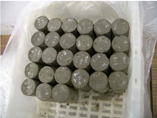
セメント配合後、強度試験を実施
