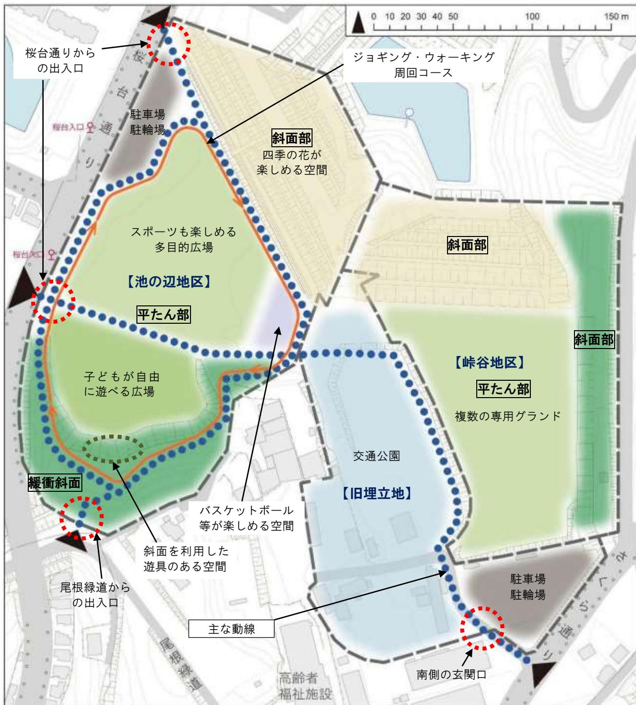
\*峠谷地区は、池の辺地区及び旧埋立地の標高に近い高さまで埋立てることを前提とします。そのため、平たん部の面積は、埋立て前の約 9,000 m<sup>2</sup>から埋立て後には約 13,000 m<sup>2</sup>になります。
