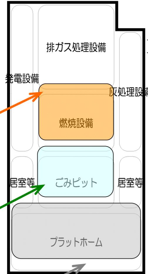
【バイオガス化施設の機能レイアウト例】
