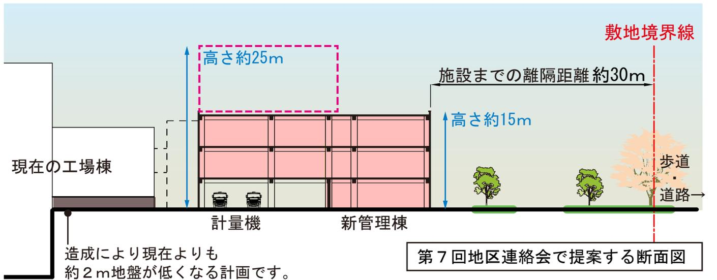
※この案で、現在の施設と同等まで壁面を後退させる場合、本日提示している平面図に示した機能を保つためには、建物の階数を5階建て相当にする必要があります。（ピンク色点線で図示した範囲です。）
