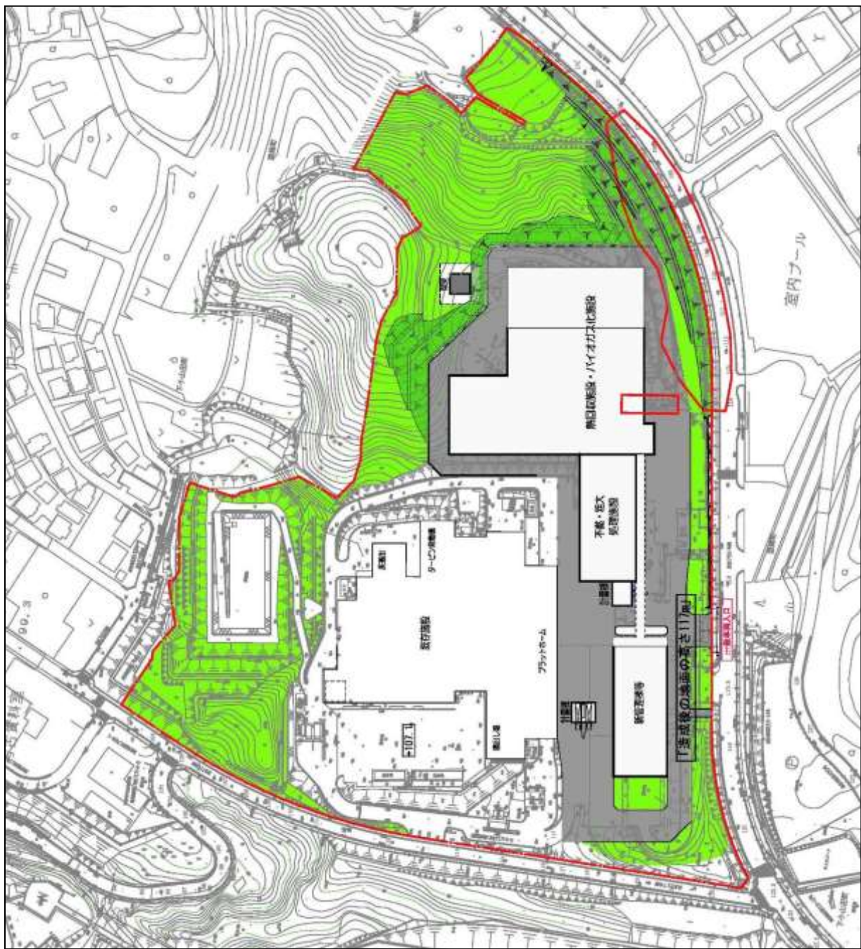
図 5・2 周辺住宅に対する緩衝帯(緑地)の状況 バイオガス発酵槽縦型配置
