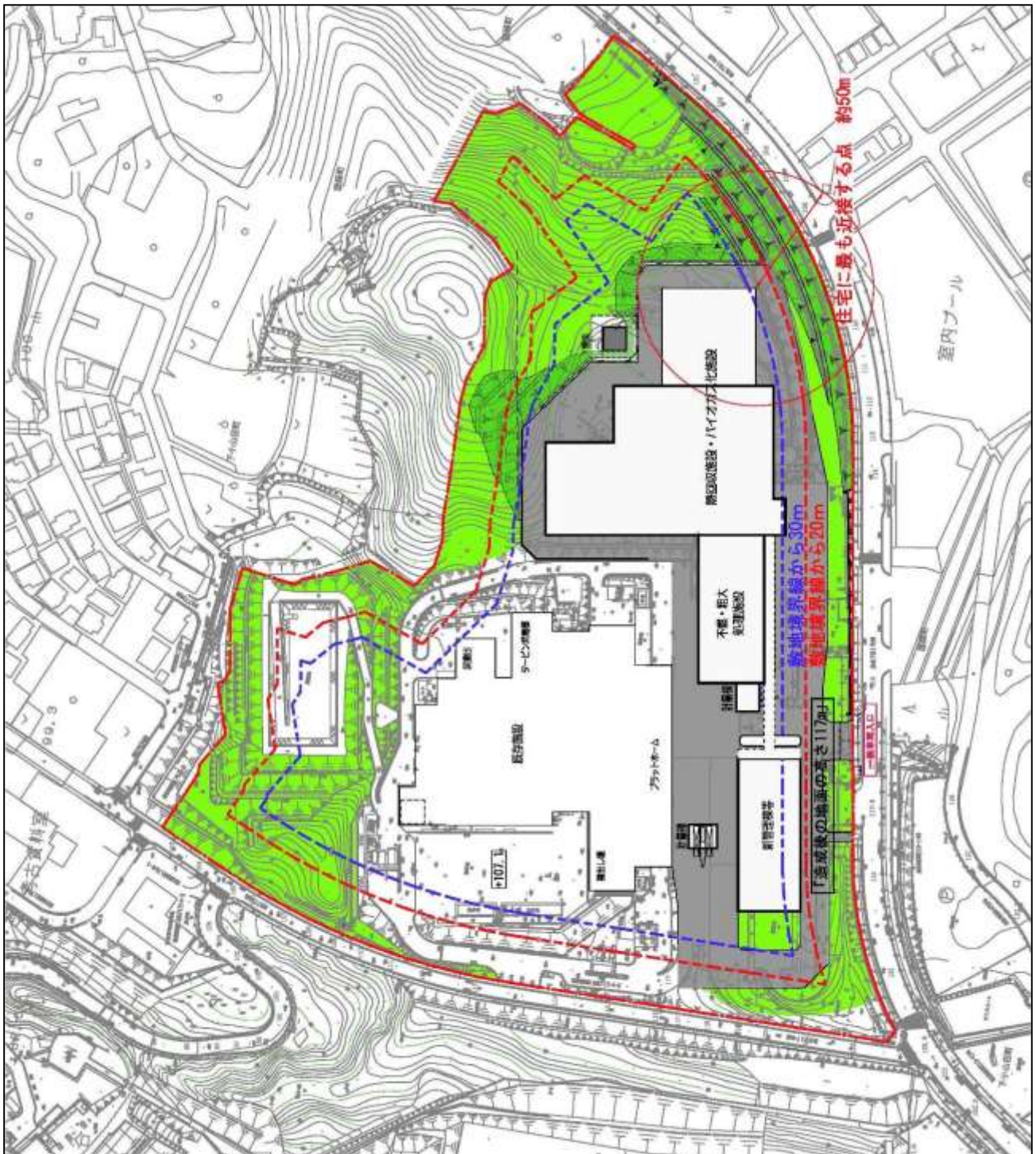
図 3-1 周辺住宅に対する緩衝帯と施設の離隔距離 バイオガス発酵槽横型配置
