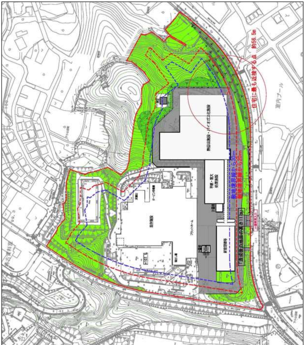
図 3・2 周辺住宅に対する緩衝帯と施設の離隔距離 バイオガス発酵槽縦型配置
