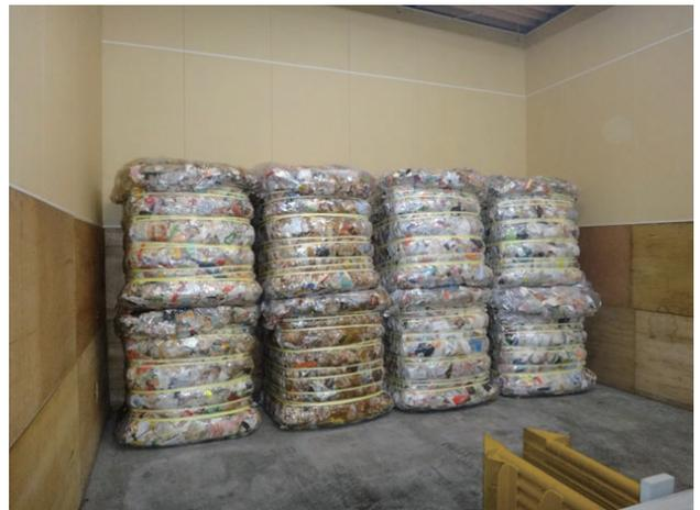
リレーセンターみなみの圧縮梱包機でボールにした容器包装プラスチックを既存工場保管後、日本容器包装リサイクル協会へ搬出
