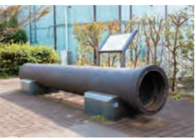
開通時に使用していた18インチ(46cm)の水管。現在の水道管150cmに比べるとかなり細いことが分かる。
