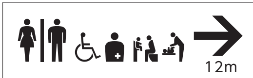
③ トイレ（便房内に設置された設備のピクトグラムを合わせて標示する）
