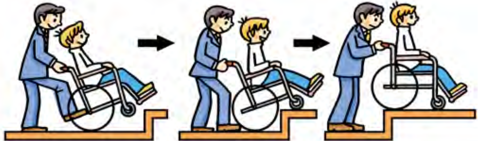
①キャスターを上げる ②キャスターを段に乗せる ③後輪をゆっくり押し上げる
