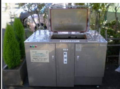
大型生ごみ処理機
