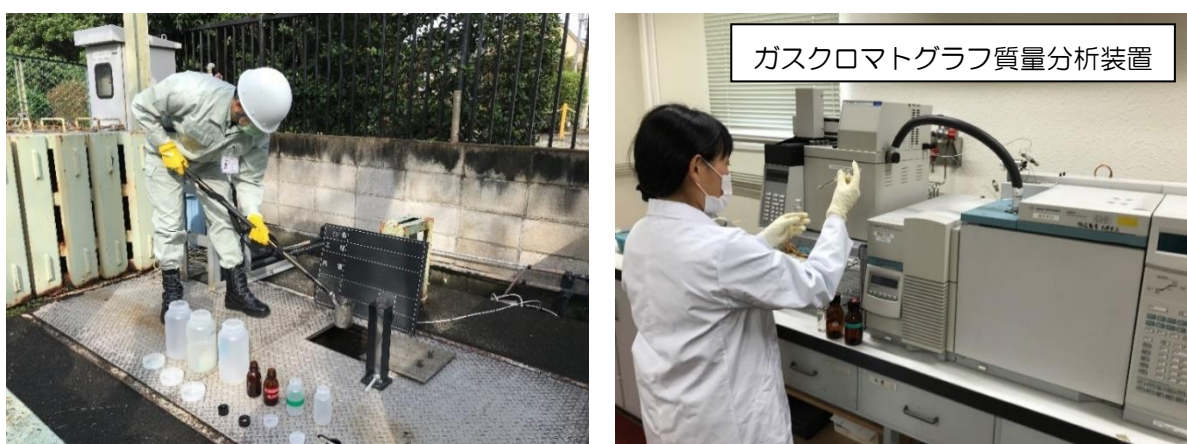
図 5-13 事業場採水の様子（写真左）及び事業場排水の水質検査の様子（写真右）
