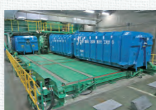
●6 コンテナ移動装置 コンテナをアームロール車に移動します。
