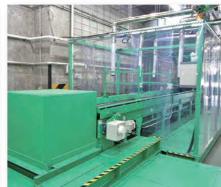
③ 手選別コンベヤ 汚れの付着した不適物や異物を人の手によって取り除いています。
