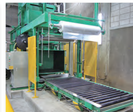
④ 容器包装プラスチック圧縮梱包機 選別した容器包装プラスチックを圧縮梱包します。
