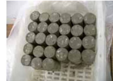
セメント配合後、強度試験を実施
