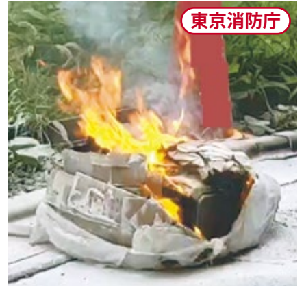
小型充電式電池が原因のごみ袋の延焼状況(提供：東京消防庁)
