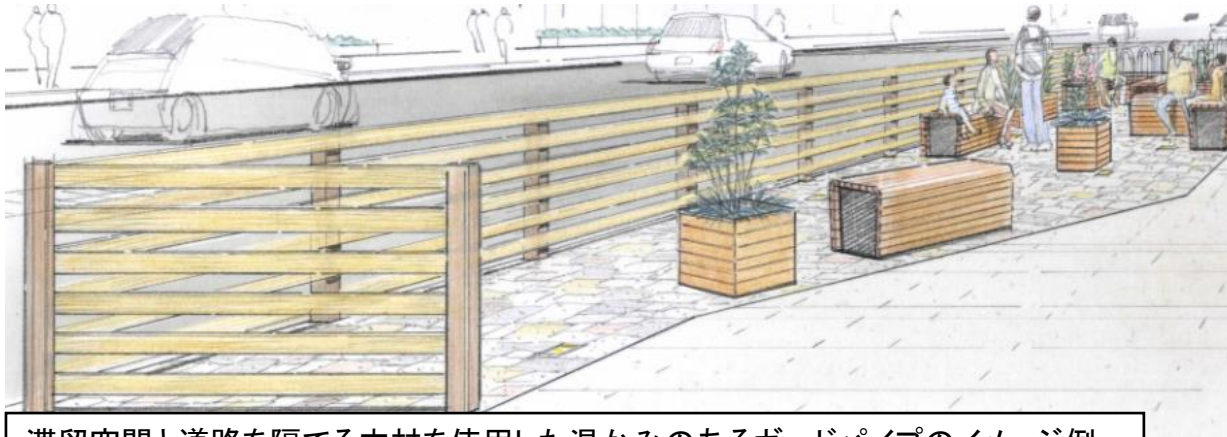
滞留空間と道路を隔てる木材を使用した温かみのあるガードパイプのイメージ例
